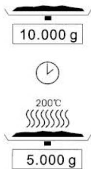
本仪器是根据热重量分析原理来进行水分测量的。即在加热烘干过程中，以样品的失重来确定水分含量，仪器基本上有2部分组成：一台精密天平，一台加热烘干装置与其他热量分析法（烘箱，红外，微波）相比，卤素型水分测定仅是用卤素烘干装置进行加热。可获得更快的测量速度，在实际测量过程中测量结果的精度还取决于样品配制及下列测量参数的正确选择
